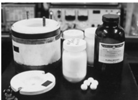
これがセラミックス人工骨づくりのための材料セット。ただ、焼き固めて形を整えるだけではなく、人体が拒絶反応を起こさないような機能を加えることも今後の目標課題だ。
